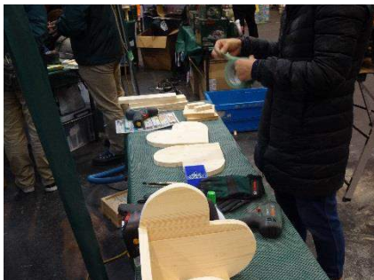
ハートはジグソーでカット。オービタル サンダーで研磨して、ビス止め。
